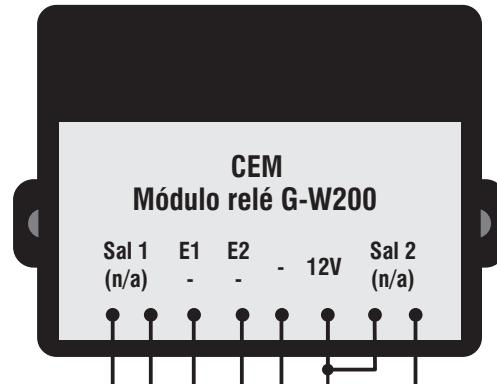
**Nota:** cualquiera de las 2 salidas puede utilizarse indistintamente con 220 Vca o 12 Vcc.
